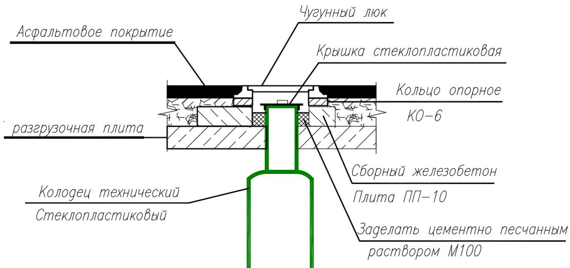
При установке стеклопластиковых изделий в обводненных грунтах и при не достаточной высоте обратной засыпки или расположении в низинах и т. д. могут быть использованы следующие схемы устройства пригрузов, предотвращающие всплытие.
