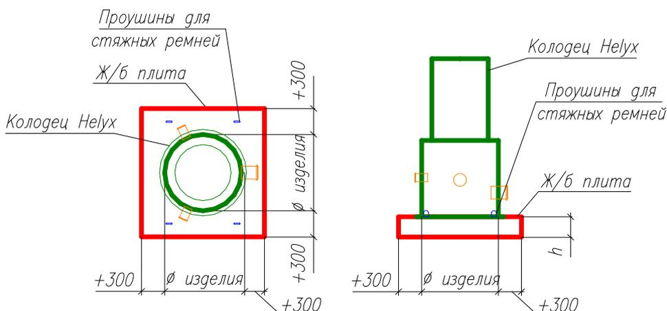
Для армирования плиты рекомендуем использовать арматуру класс АIII диаметром Ø12 мм с шагом 200X200 мм. При изготовлении плиты внизу котлована достаточно армирования в одну сетку. При изготовлении плиты на бровке котлована рекомендуем армировать в две сетки во избежание поломки плиты при монтаже краном. В качестве закладных деталей (проушин для крепления стяжных ремней) использовать арматуру класс АI диаметром Ø16 мм.
