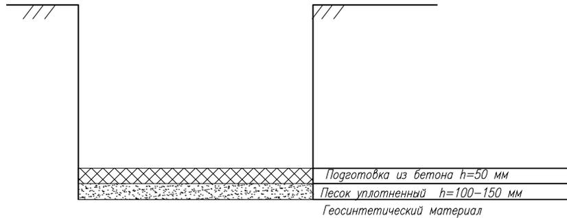
Для установки вертикальных стеклопластиковых изделий подготовка дополнительного основания на ж/б плиту не требуется.
