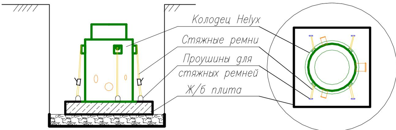
Стяжные ремни можно заказать в качестве дополнительного оборудования на [helyx-systems.com](http://helyx-systems.com).
