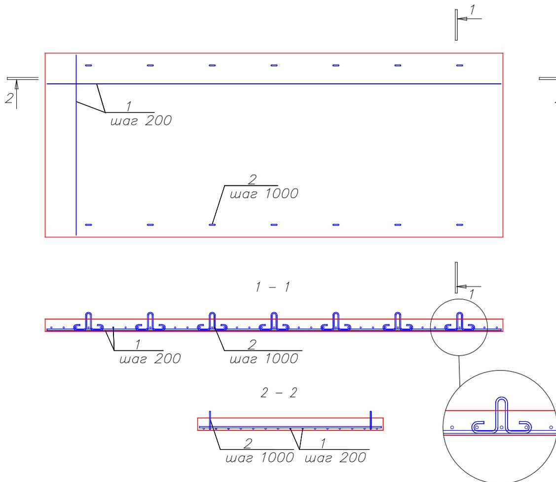
Узел детализировки закладной детали (проушина для крепления стяжных ремней)
