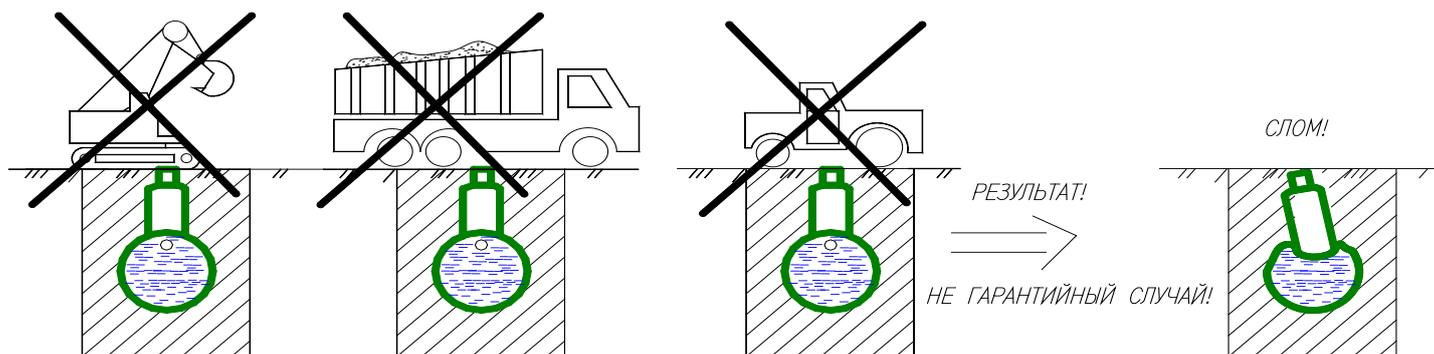
Запрещается движение автотранспорта и тяжелой строительной техники после обратной засыпки котлована с установленными в нем стеклопластиковыми изделиями в избежание повреждений.
