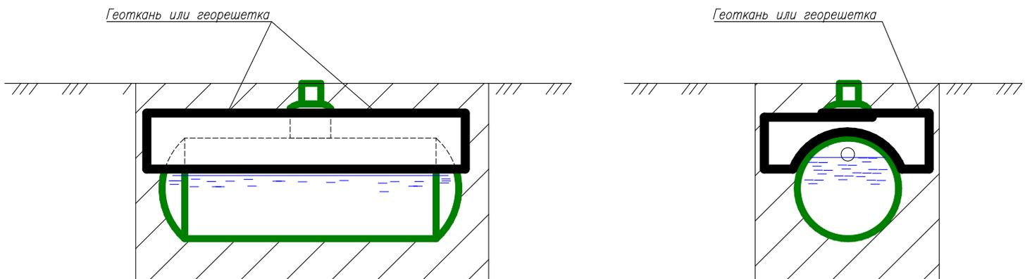
В качестве пригруза против сил всплытия используется собственный вес грунта, который заворачивается в верхней части в слой геосинтетического материала или геосетки.
