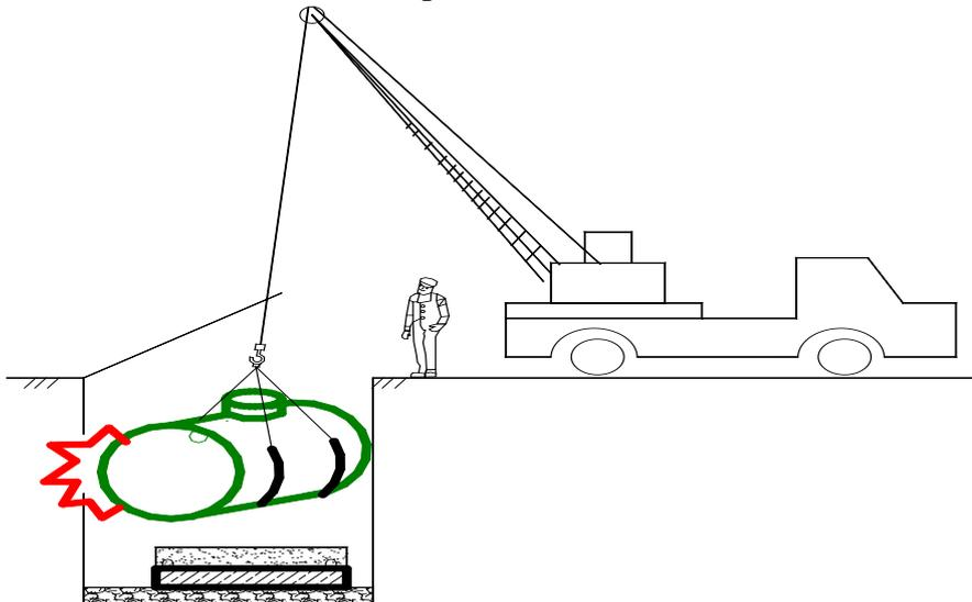
При перерывах в монтаже емкостей необходимо зафиксировать емкости от смещения и всплытия (путем наполнения водой) прикрыть открытые горловины временными заглушками исключить попадания внутрь емкостей грязи или посторонних предметов.
