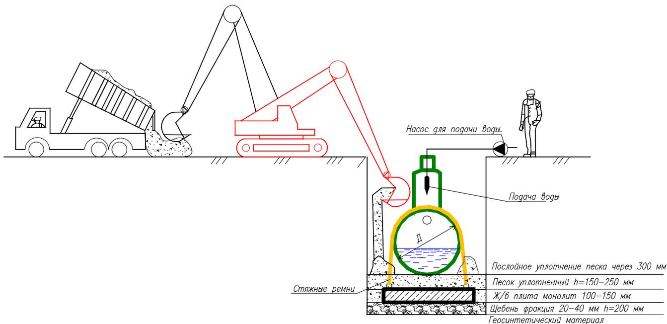
**ВНИМАНИЕ.** Одновременно с обратной засыпкой необходимо производить наполнение стеклопластиковых емкостей водой для предотвращения её всплытия, выдавливания и смещения.
