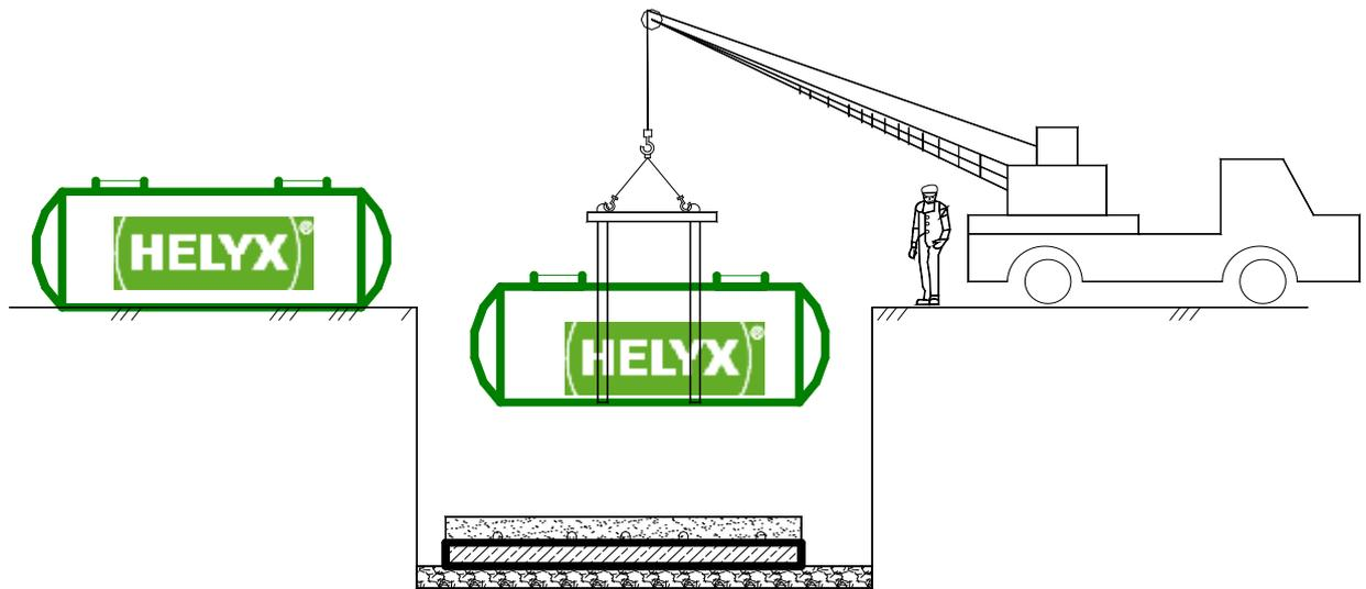
**До начала монтажа проверьте горизонтальность плиты.**
