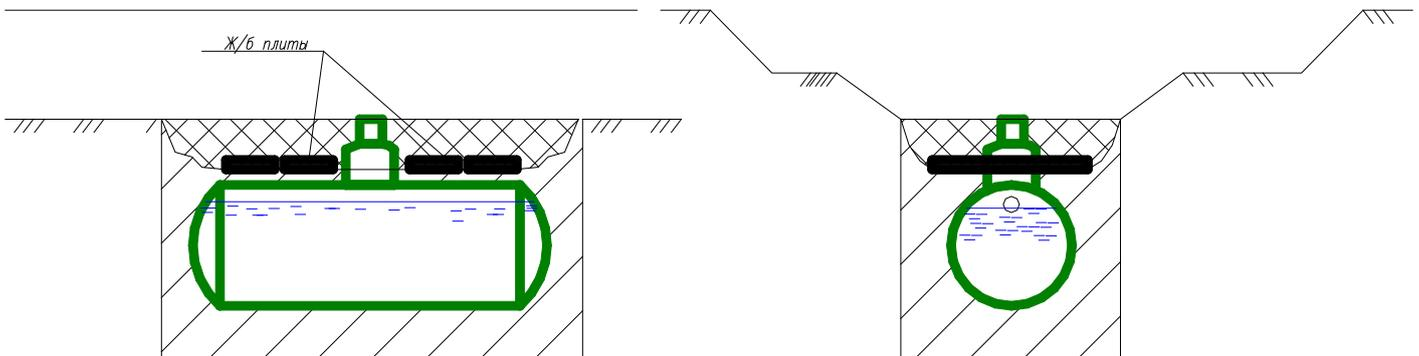
В качестве пригруза используются ж/б плиты, укладываемые на песок поверх емкости, которые противодействуют силам всплытия.
